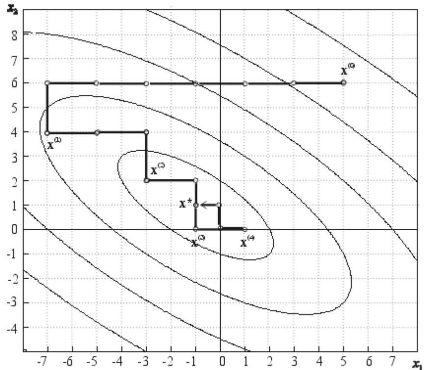
Рис.2. Иллюстрация работы метода Гаусса-Зейделя
